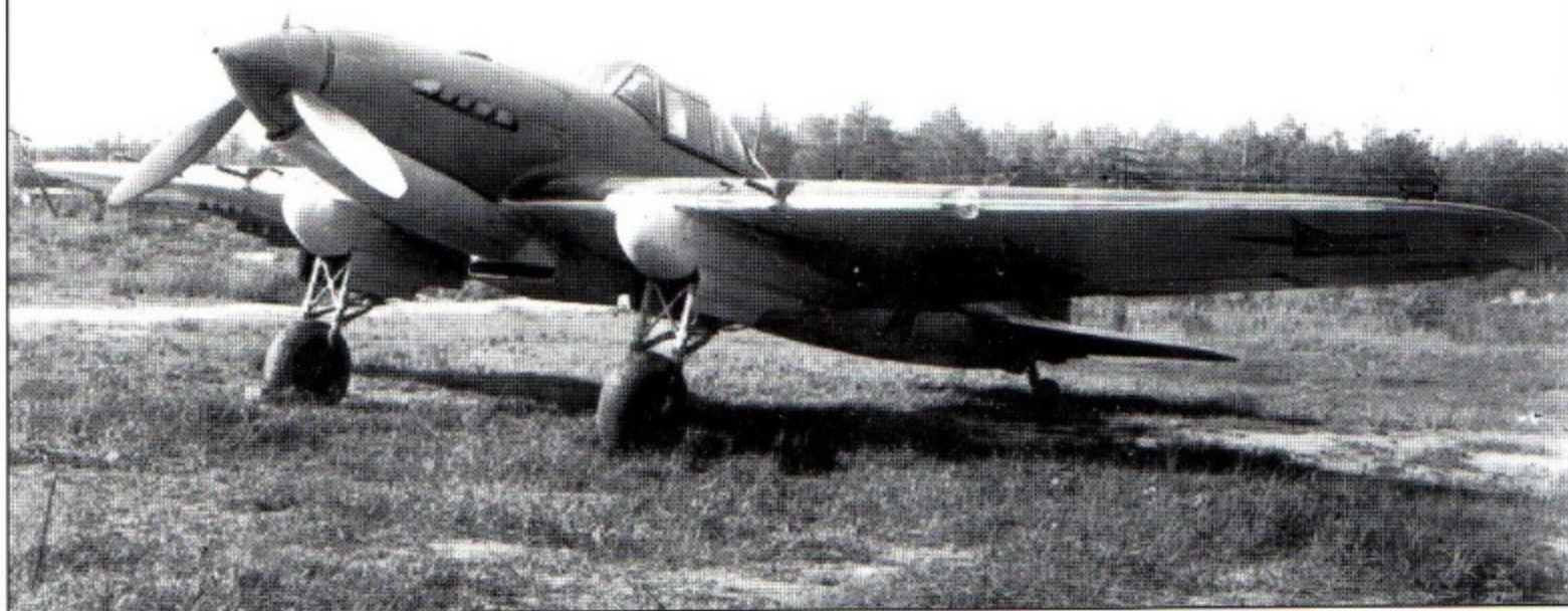
Ил-2 АМ-38 с пушками ВЯ-23 производства авиазавода № 18
