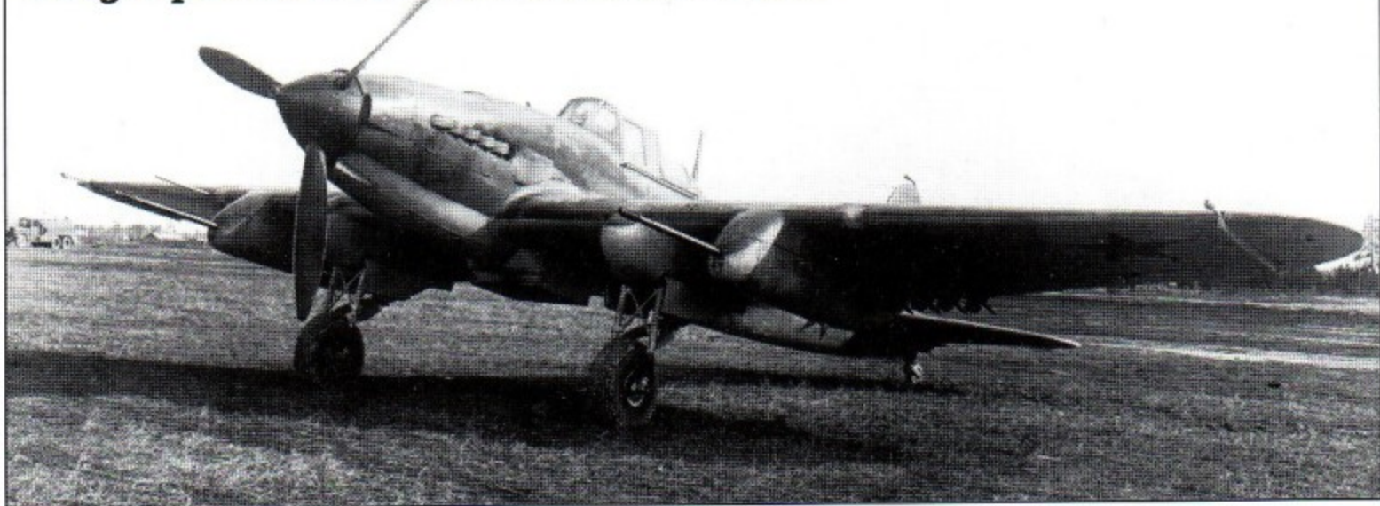
Ил-2 АМ-38 с крупнокалиберными пушками ШФК-37. Государственные испытания, 1941 г.
