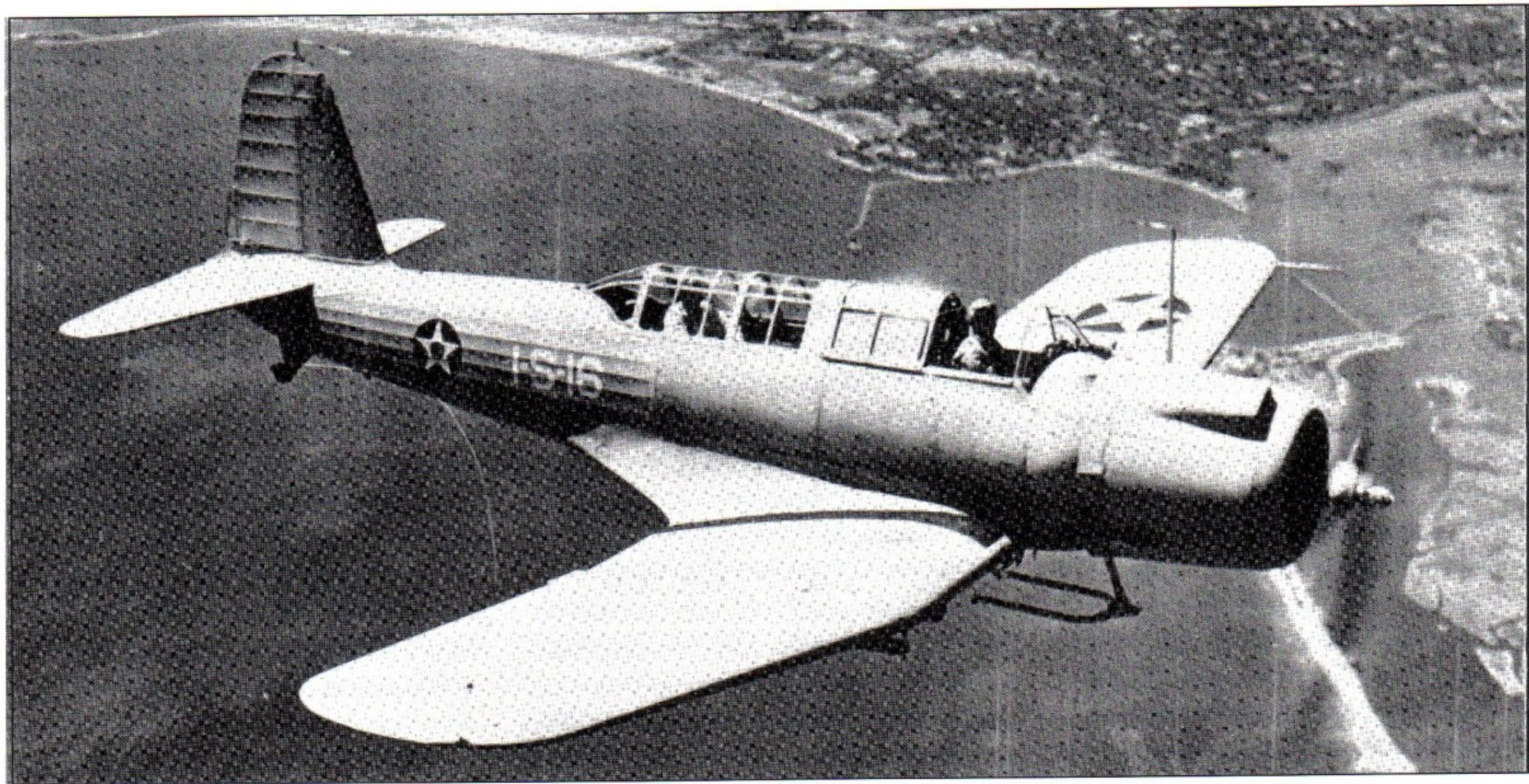
Самолёт SB2U-3, борт 1-S-16, из состава эскадрильи VMS-1 в полёте в 1941 г. Самолёт был целиком окрашен матовой светло-серой краской (Non-specular Light Grey) и нес на фюзеляже опознавательный знак США – звезду. Все буквы и цифры – белого цвета. (Снимок фирмы «Воут», предоставил B.R. Jackson).
